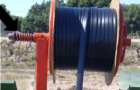
Es recomendable usar el Tractor a no más de **10 Km/Hr** aproximado, de ser más Km/Hr es recomendable revisar frecuentemente la instalación de la manguera, a más Km/H puede dañar gravemente a la manguera de goteo.
