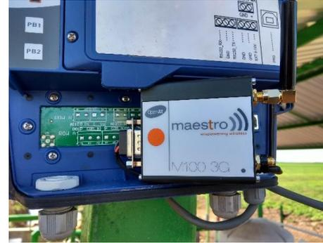
El **rSense** es el dispositivo que se instala en campo, es el encargado de recibir la información de los sensores de humedad y del medidor que se conecta en la manguera de riego.
